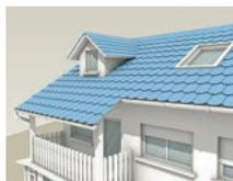
Le tegole del tetto vanno controllate annualmente, provvedendo a fissare quelle che si sono staccate e a sostituire quelle danneggiate. Ogni cinque-dieci anni fate ispezionare il tetto da professionisti, in particolare i dispositivi di fissaggio. In zone esposte ai venti utilizzate appositi ganci fermategole.
