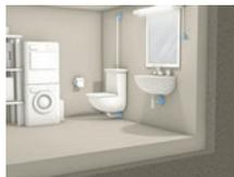
Attraverso condutture o pozzi all'interno dell'edificio (tubi per acqua, gas, cavi elettrici, telefonici, TV, riscaldamento nonché camini, canali di installazione e pozzi per ascensori o scivoli per biancheria), il radon può penetrare nei locali di abitazione. Si dovrebbe quindi provvedere ad una sigillatura e ad un isolamento a regola d'arte.
