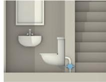
Installate valvole antiriflusso per impedire l'innalzamento del livello dell'acqua ed evitare così che la piena entri attraverso la canalizzazione.
