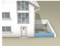
Proteggete la porta del garage e l'accesso al garage sotterraneo con paratie certificate o in caso di garage sotterranei create una contropendenza.
