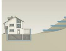
Rinforzate la piastra di fondazione. Metodo di costruzione monolitico (edificio composto da un solo blocco) e separazione statica dell'edificio principale da quelli annessi. Installazione di una condotta di scarico per l'acqua piovana e di sistemi di drenaggio per i declivi in modo da garantire il prosciugamento ottimale dell'acqua.
