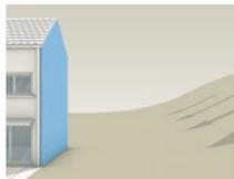
Consolidez la partie du bâtiment exposée au danger et n'y construisez pas de portes ou de fenêtres.
