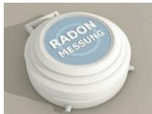
Pour les bâtiments avec fondations, l'Office fédéral de la santé publique (OFSP) conseille une mesure du radon, même lorsque le risque lié au radon est faible. L'OFSP a publié une liste des services de mesure du radon agréés pour l'acquisition et l'évaluation de dosimètres.
