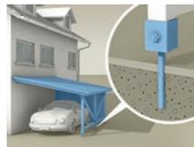
Ancrage des éléments de bâtiment exposés au vent (p. ex. toit, box-garage).
