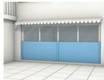
Agencez si possible vos fenêtres du côté opposé au couloir d'écoulement ou consolidez-les pour les rendre étanches à l'eau et protégez-les par un système anti-inondation certifié.
