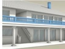
Fixez les parapets, cheminées ou éléments de façade non fixés ou insuffisamment fixés ainsi que les tuiles de toit lâches ou les murs isolés, susceptibles de basculer ou de tomber en cas de secousses.
