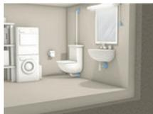
Le radon peut s'infiltrer dans les pièces d'habitation par les conduites ou les gaines situées à l'intérieur du bâtiment (conduites d'eau et de gaz, câble électrique, câble TV ou câble téléphonique, chauffage, cheminée, gaines techniques, cages d'ascenseur ou dévaloir à linge). C'est pourquoi celles-ci devraient être étanchéifiées dans les règles de l'art.
