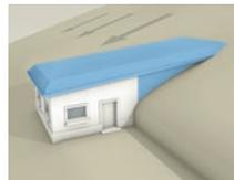
Si la topographie est adaptée: construction d'un toit-terrain recouvert de terre.
