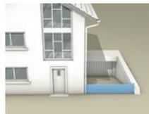
Protégez l'accès au portail de garage et au garage souterrain par un système anti-inondation certifié ou, pour un garage souterrain, prévoyez une contre-pente.
