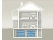
Une concentration élevée en radon concerne en règle générale les pièces situées à hauteur du sol, c'est-à-dire au sous-sol ou à flanc de coteau. Les logements au rez-de-chaussée, situés au-dessus d'une cave ou d'un vide, sont notamment également concernés.
