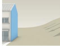
Consolidation du côté du bâtiment exposé au danger. Si possible, côté montagne, ne montez pas de portes ou de fenêtres, à défaut, uniquement de petites fenêtres. Fermez les portes de l'extérieur.
