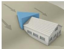
Du côté du bâtiment faisant face à la montagne, construction d'un coin diviseur (forme protectrice qui disperse et dévie les coulées de boue) ou d'une digue de déviation.
