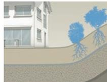
Pour les glissements de terrain superficiels (jusqu'à 2 m), plantation sur la pente d'arbustes et d'arbres à racines profondes.
