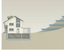
Consolidation du sol. Construction monolithique (bâtiment en un seul bloc) ainsi que séparation statique du bâtiment principal et de l'extension. Installation d'une conduite d'écoulement pour les eaux de pluie et le drainage de la pente pour un sol parfaitement drainé.
