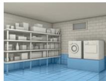
Les sols, murs et plafonds doivent être construits de préférence dans des matériaux non sensibles à l'humidité comme le béton, la pierre naturelle et la brique, le métal, le plastique ou le verre.
