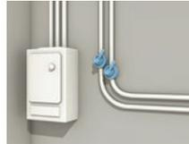
Disposition des installations techniques et électriques au-dessus du niveau d'eau maximal, conduites d'alimentation séparées selon que les parties du bâtiment se situent au-dessous ou au-dessus du niveau d'eau maximal.
