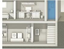
Le radon peut entrer dans le logement par des escaliers ouverts, menant du sous-sol à l'étage supérieur. Les escaliers ouverts doivent de ce fait toujours être fermés au sous-sol par une porte étanche. Les escaliers de cave ouverts doivent être fermés au moins à un endroit par une porte étanche. Mieux vaut toutefois un accès à la cave par un escalier extérieur.
