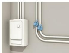
Collocate gli impianti elettrici e domestici sopra il livello massimo dell'acqua, assicurate un instradamento separato per l'approvvigionamento delle parti dell'edificio che si trovano sopra e sotto il livello massimo dell'acqua.
