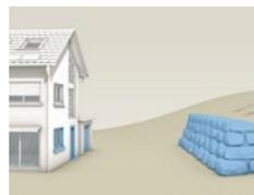
Se possibile, non costruite finestre e porte sul lato rivolto verso la montagna. Proteggete le finestre con traverse di acciaio e le porte con muri di protezione o valli di protezione locali.
