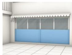
Se possibile costruite le finestre sul lato opposto alla corrente oppure rinforzatele contro l'acqua e proteggetele con paratie certificate in base al livello massimo dell'acqua.
