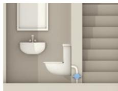
Einbau von Rückstauklappen, die das Aufsteigen und Eindringen von Hochwasser durch die Kanalisation verhindern.
