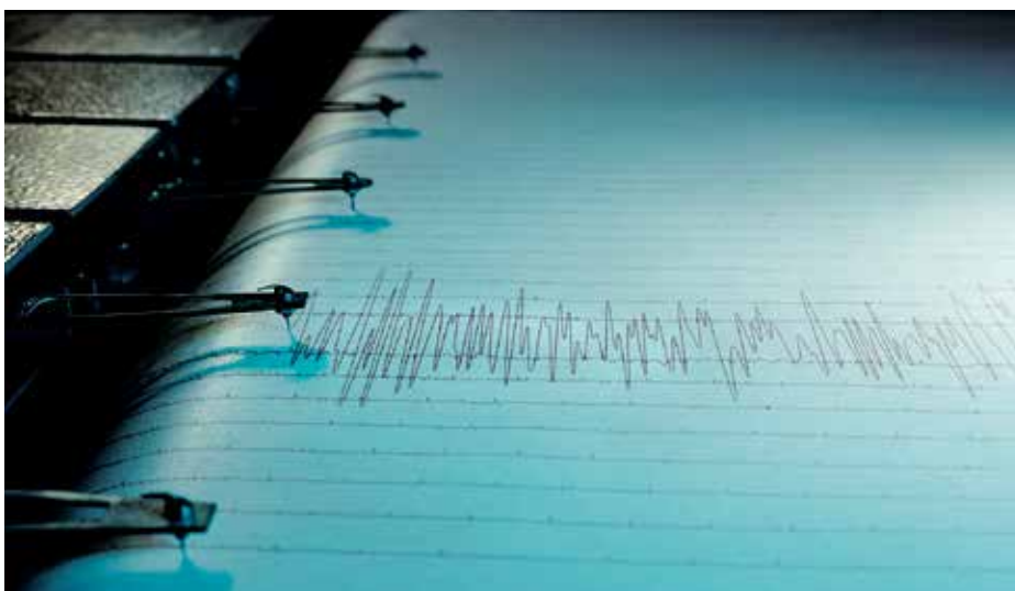
Ein Netz von Seismographen dient dazu, den genauen Ort und Zeitpunkt eines Erdbebens, über Kontinente hinweg, festzustellen.
